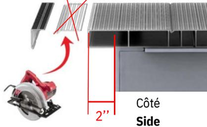
La moulure de finition M-2 exige une distance de surplomb de 2" entre le plancher et la structure.
