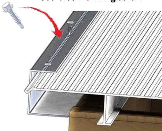
Ajoutez les coins en polycarbonate et fixez-les avec des vis autoforeuses.
